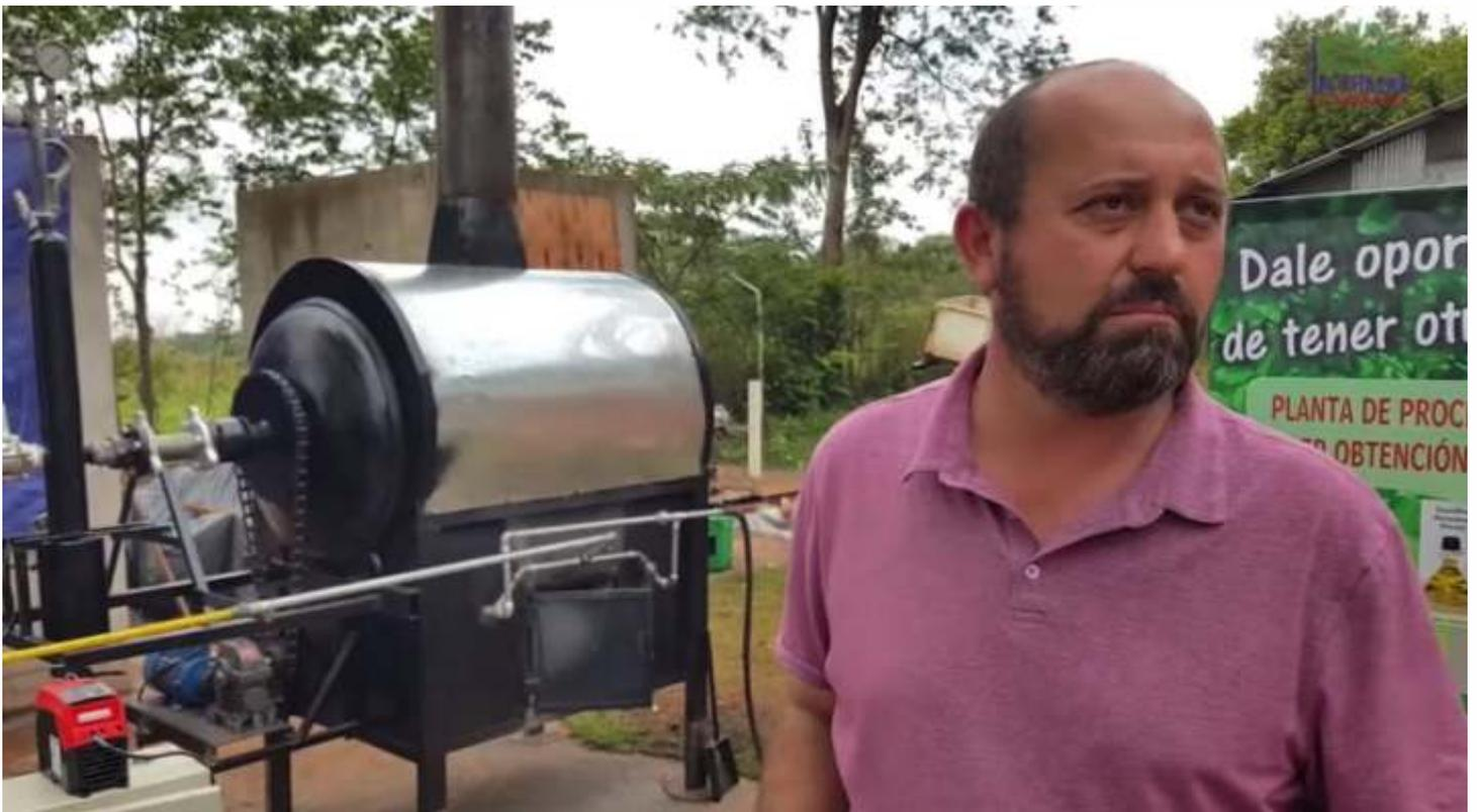
**Walter Rosner, investigador y metalúrgico Argentino**, ha diseñado y fabricado un reactor que es capaz de convertir plástico en combustible para vehículos y máquinas. En este proceso además se obtienen otros materiales como aceites, brea para asfalto y carbón.
