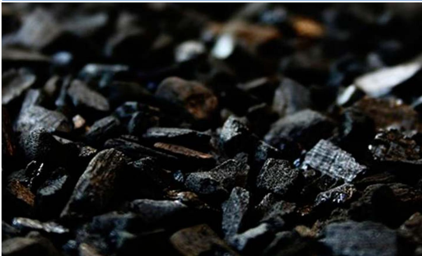
La remoción de los metales de plomo y cromo en aguas contaminadas con los mismos es posible mediante el uso de carbón activado obtenido a partir de la semilla de aguaje.
