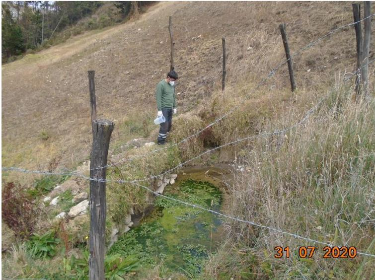
*Foto 7. Punto de monitoreo S21A. Manantial ubicado en margen derecha de quebrada Yanacocha, en el terreno de Sra. Elías Palacios Lucano. No fue posible efectuar un aforo por tratarse de una filtración que aflora en una poza excavada en el terreno natural. Fecha: 31 de julio de 2020..*
